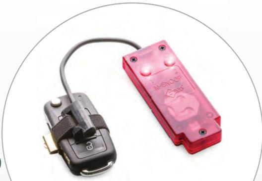
**2** Recolección de datos. Asegure el M-Snoop alrededor de la cabeza de la llave original y cicle el switch de ignición 3 veces. Los Leds del M-Snoop se iluminarán indicando que la obtención de datos fue exitosa.
